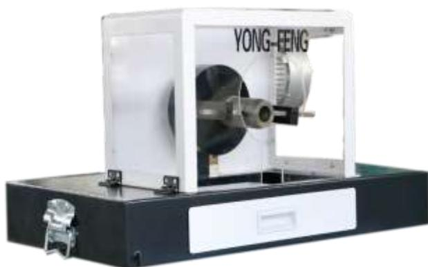
Окорочный станок YONG FENG FS51 используется для зачистки внутреннего и внешнего резиновых слоев гидравлических шлангов. Диапазон зачистки составляет 6 ~ 80 мм. Окорочный станок для шлангов YONG-FENG S51 оснащён редуктором для стабилизации скорости. В целях безопасности машина автоматически прекратит работу, если будет открыта защитная крышка.
